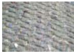
Figura 40. Acabat del feltre després del procés de termoconformat
