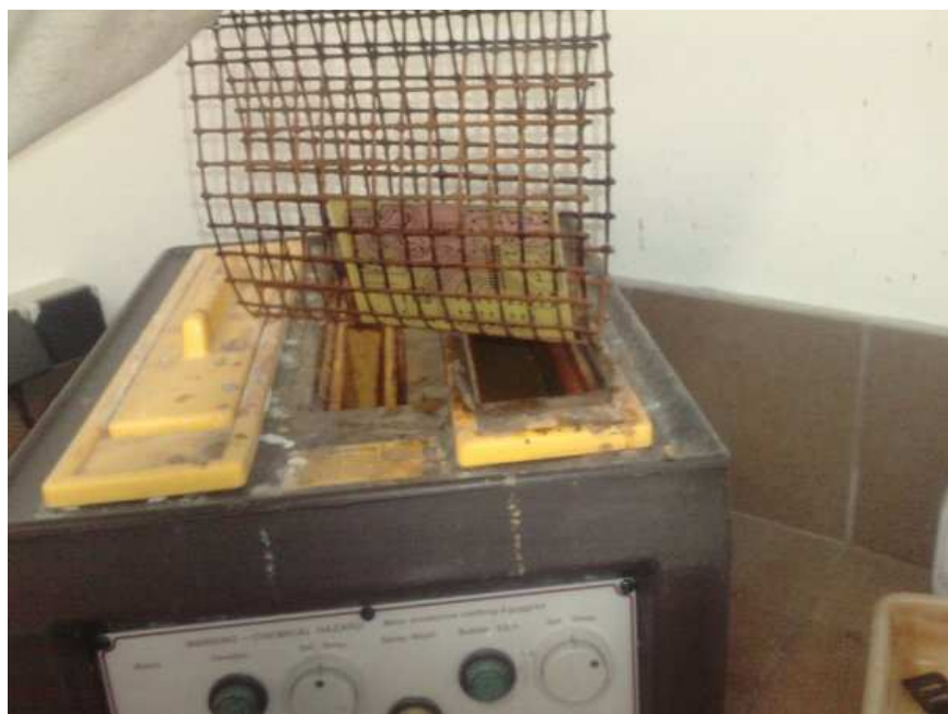
Figura 5.1.4. –Procés d'eliminació del coure
