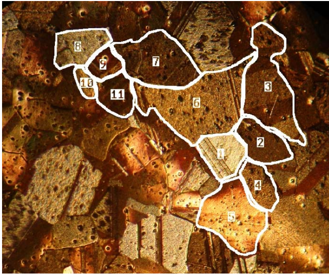
Figura 6.7. Procés de mesura de la mida aparent de gra amb el mode normal.
