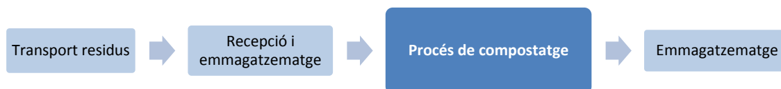
Figura 24 Etapes del procés de compostatge. Font: ARC.
