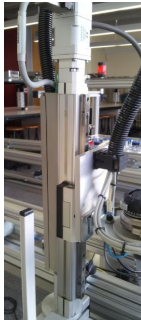
Imatge 26 - Eix elèctric palets
