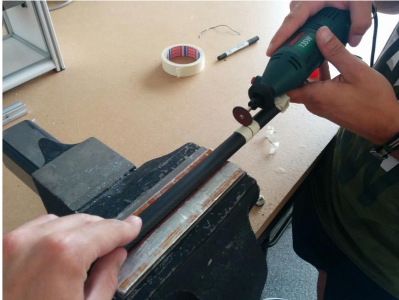
Fig. 3.40. Tall de la barra de carbono.
