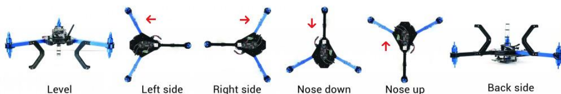
Fig. 5.5. Orientacions calibratge acceleròmetre.
