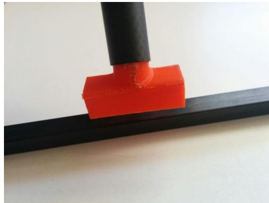
Fig. 6.6. Col·locació peça impresa del tren d'aterratge.
