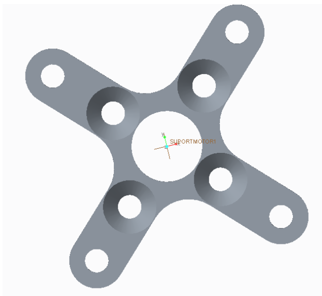
Fig. 3.14. Dibuix 3D de l'adaptador per collar els motors.
