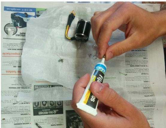
Fig. 6.7. Aplicació de fixador als cargols.
