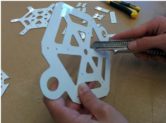
Fig. 6.5. Repàs i neteja de les peces després del fresat.
