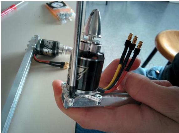
Fig. 6.3. Muntatge motor en el seu suport.
