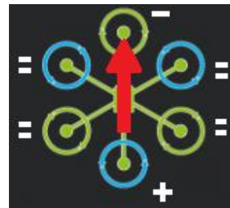
Fig. 3.1. Gir dels motors per trajectòria indicada
