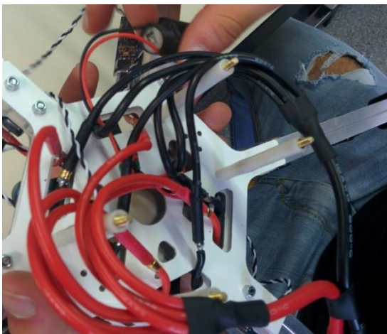
Fig. 6.10. Instal·lació d'alimentació dels ESC i del BEC.
