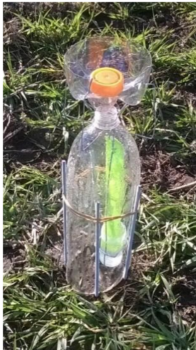
Figura 2. Cámara semiestática-abierta colocada en la parcela.
