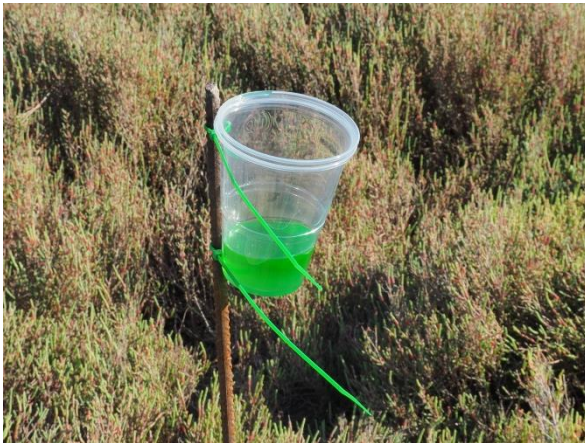
Figura 11: trampa de caiguda (infall) per a les emergències aquàtiques.
