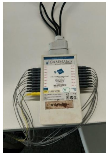
Figura 28. g.GAMMAbox d'un cap d'EEG amb tots els canals connectats i connectat a l'amplificador.
