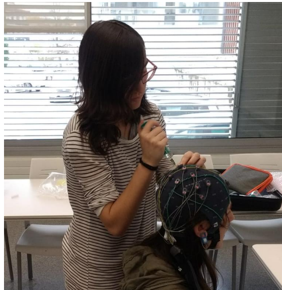
Figura 26. Aplicació del gel. Cada elèctrode té un forat per tal de que la xeringa pugui posar el gel entre el elèctrode i la pell.
