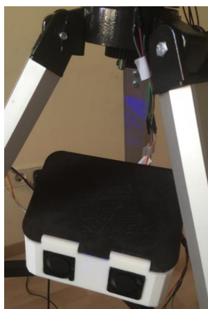
Figura 51. Caixa elèctrica amb els dos ventiladors de refrigeració
