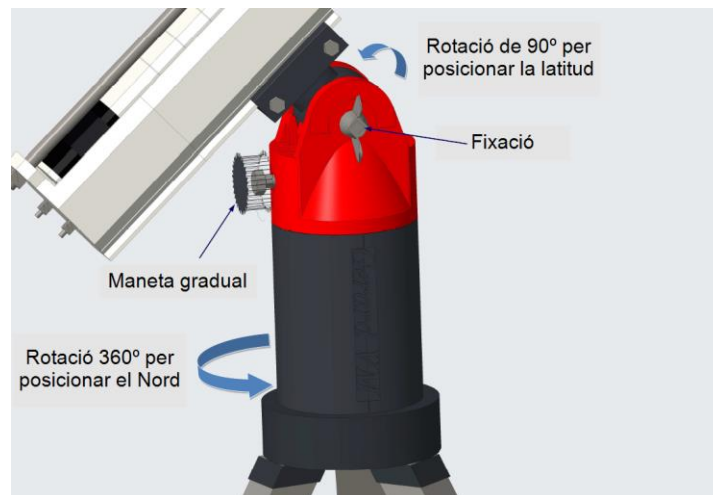
Figura 31. Suport de la muntura amb 2 graus de llibertat
