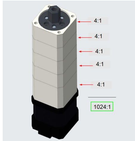
Figura 28. Reductor epicycloidal amb una reducció de 1024:1
