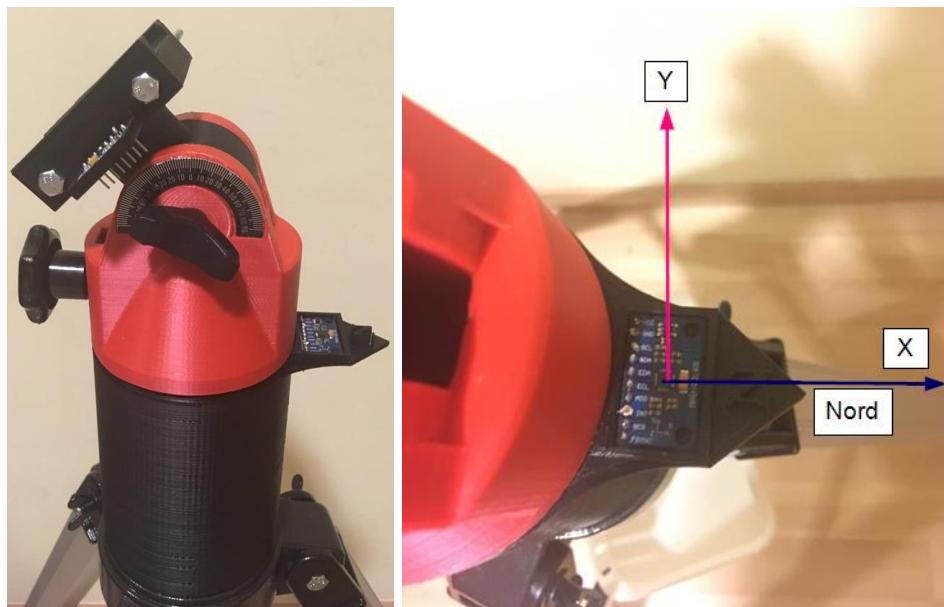
Figura 49. MPU-9250, sensor per mesurar que el trípode està paral·lel al terra i garantir que està posicionat al Nord.
