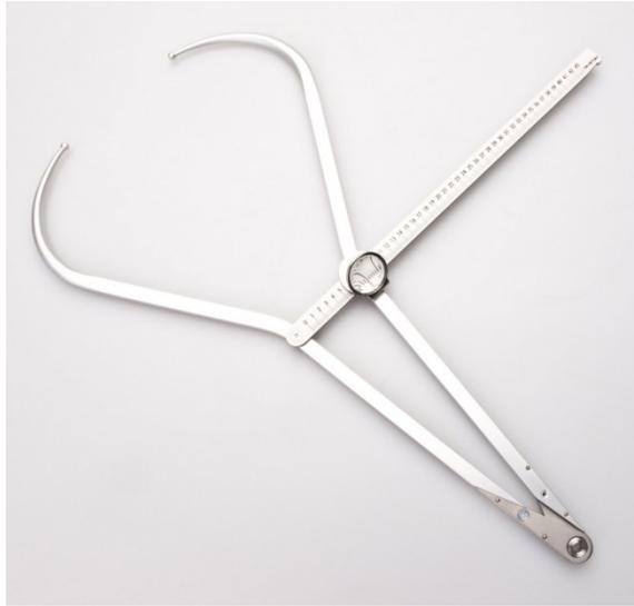
**Compas o “Spreading caliber” por medidas antropométricas**
