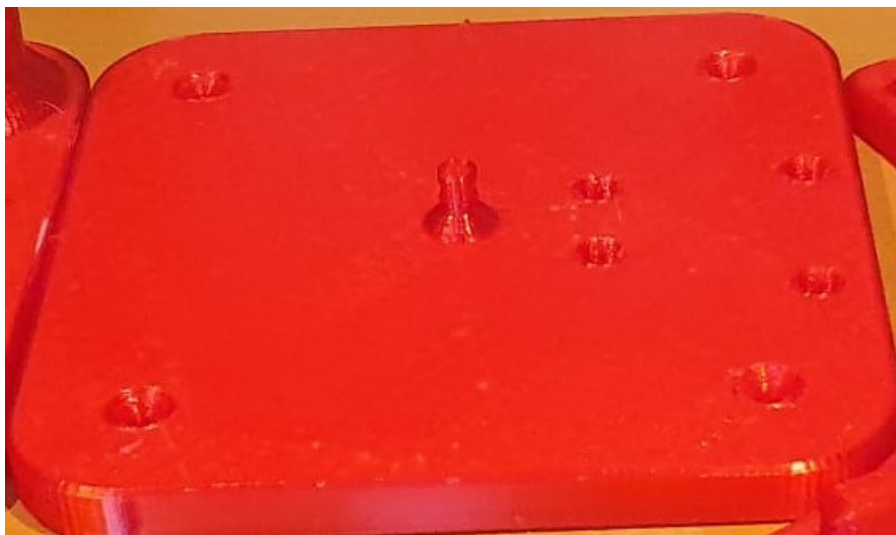
Figura 4.14: Base superior impresa en 3D.
