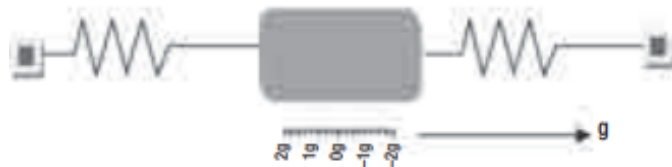
Figura 2. Esquema d'un acceleròmetre mecànic. Extret de Pérez-Soriano et al., (2018).
