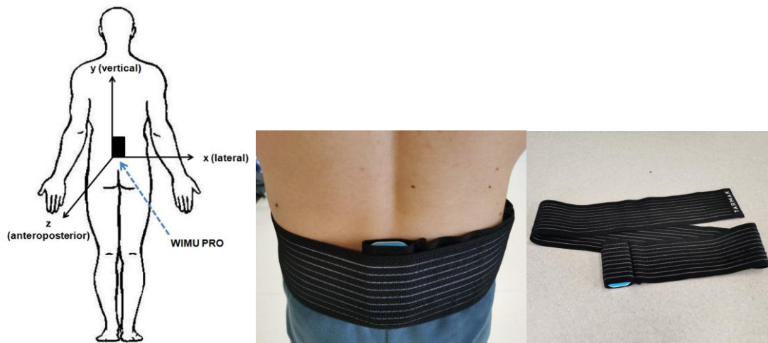
Figura 8. Esquema del lloc de col·locació i orientació del dispositiu WIMU PRO amb els respectius eixos (imatge esquerra). Imatge del dispositiu col·locat a la zona lumbar – sacre (imatge central). Vena de compressió elàstica amb cavitat pel dispositiu (imatge dreta).
