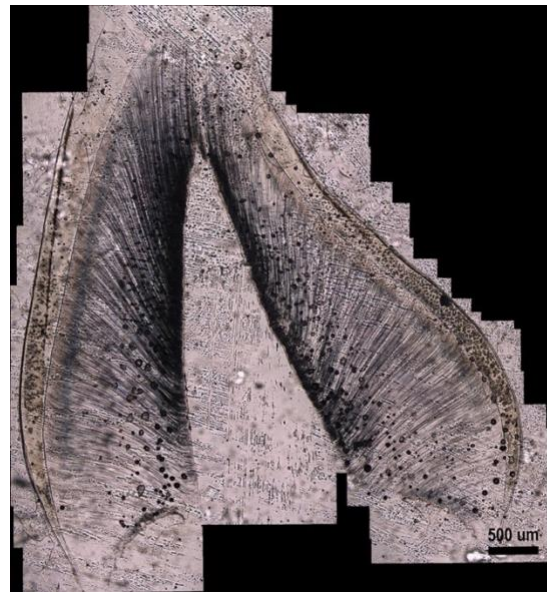
Figura 25. Resultat del desbast amb el paper de 2000 µm, observat a 5x amb el microscopi de llum polaritzada. El nombre de ratlles disminueix. Font: pròpia.
