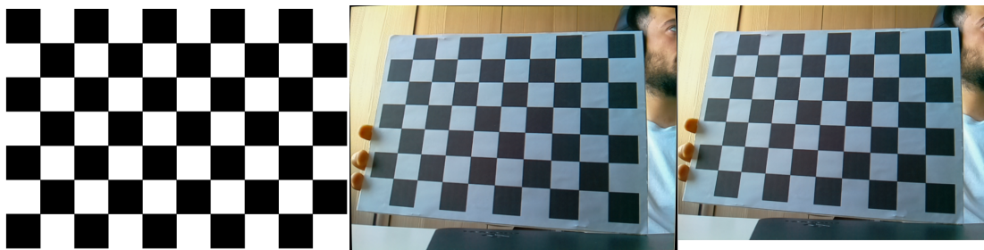
Figura 5.1 a) Patrón b) Imagen calibrada c) Imagen calibrada y recortada
