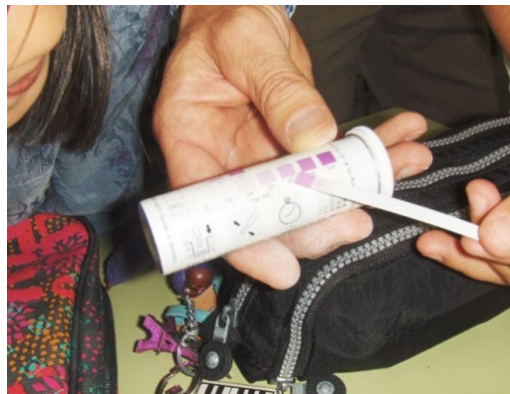
Figura 3-6 Anàlisi de nitrats per tira reactiva. Comparativa de colors. Font: pròpia.
