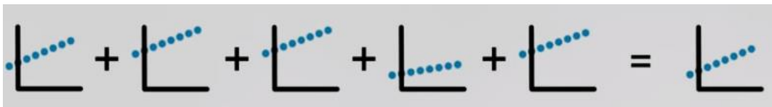
Il·lustració 10: Representació d'una suma de diferents regressions lineals equivalent a la suma de diferents neurones en el model monocapa.
