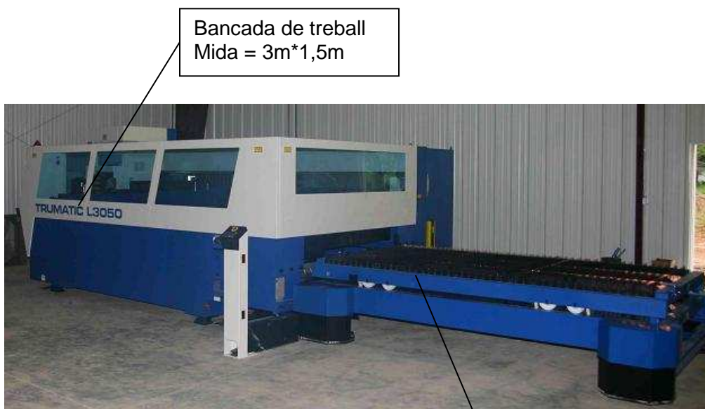
Figura 2. Màquina de tall làser TRUMPF L3050
