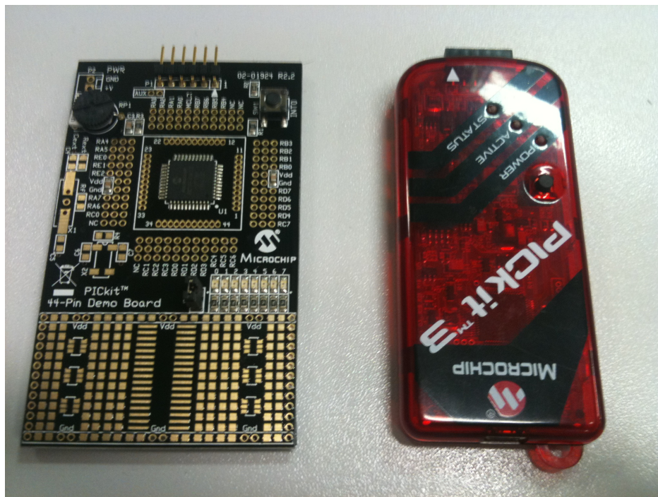
Imatge 10 Demo Board "44-pin Demo board" i gravador Pickit 3
