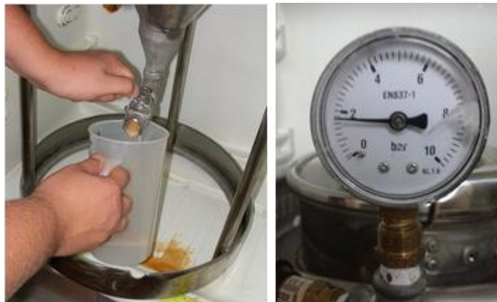
Fig 68: Purga del fang de llevat (esquerra) i manòmetre indicant 1,7 bar. Imatge pròpia
