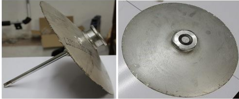
Fig 27: Part superior del tanc de cocció (esquerra) aprofitat per a la tapa del tanc de maceració (dreta). Imatge pròpia
