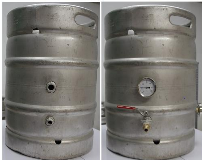
Fig 39: Tanc de cocció/escalfament amb les perforacions i mascles (esquerra) i amb els elements instal·lats (dreta)
