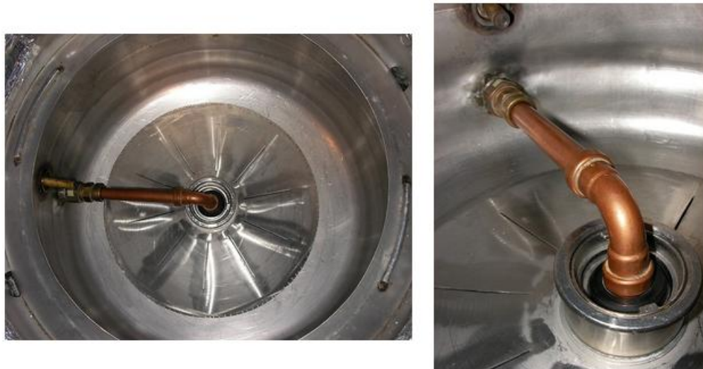
Fig 31: Vista interior del tanc de maceració amb el filtre i el tub en forma d'ela col·locats a la base del recipient. Imatge pròpia
