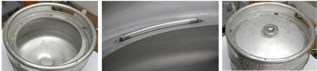
Fig 28: Topalls soldats a la part superior del tanc per fixar-hi la tapa i tapa fixada a pressió. Imatge pròpia
