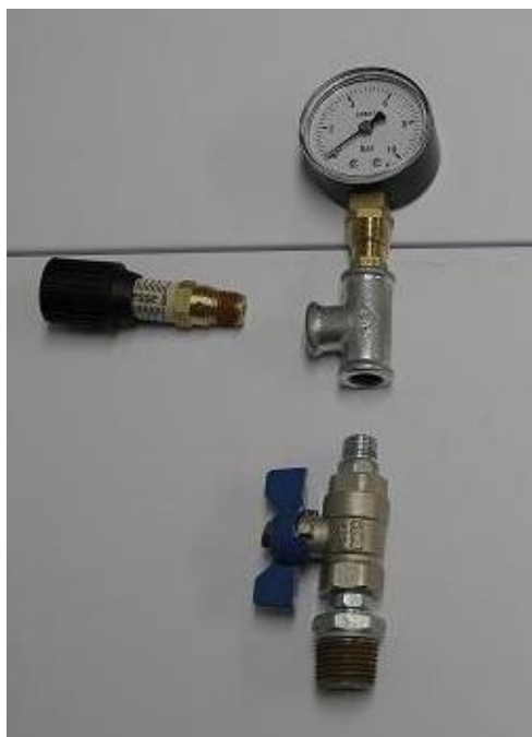
Fig 50: Elements del controlador de pressió. Vàlvula reguladora de pressió (esquerra), manòmetre vertical connectat a la T d'acer (dreta) i vàlvula de pas (a sota). Imatge pròpia
