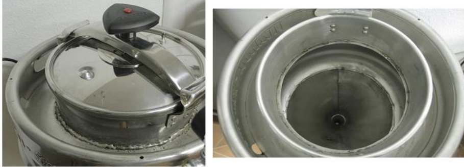
Fig 43: Olla a pressió soldada a la part superior del tanc de fermentació (esquerra) i vista de l'interior del tanc (dreta). Imatge pròpia
