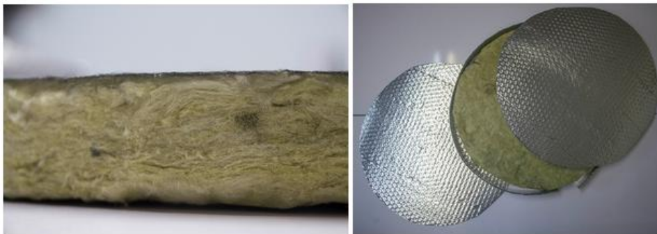
Fig 34: Llana de fibra de roca (esquerra) i parts amb què s'ha construït l'aïllant de les bases del tanc (dreta). Imatge pròpia
