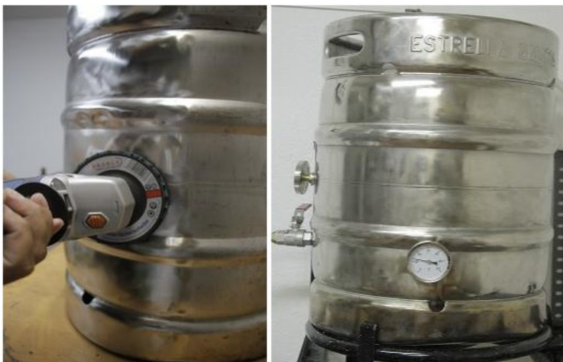
Fig 41: Procés de desbast del tanc de cocció/escalfament (esquerra) i acabat final (dreta). Imatge pròpia
