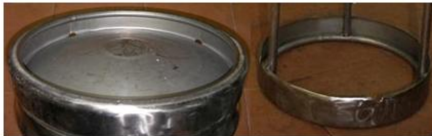
Fig 44: Base del barril (esquerra) emprat per a l'estructura del tanc de fermentació (dreta). Imatge pròpia
