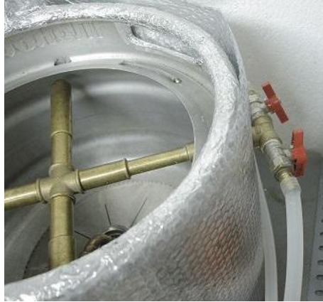
Fig 32: Sistema de recirculat: creu de llautó connectada a dues vàlvules. Imatge pròpia
