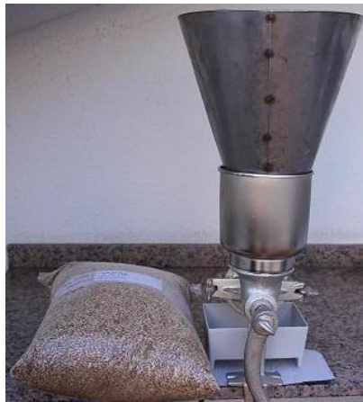
Fig 26: Molí corona amb una tremuja de fabricació pròpia. Imatge pròpia
