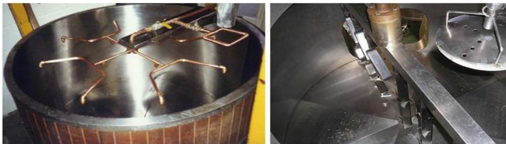
Fig 15: Tanc de maceració amb sistema de recirculat (esquerra) i detall de sistema de filtrat d'un tanc de maceració (dreta). Imatges extretes de www.ballards-brewery.co.uk
