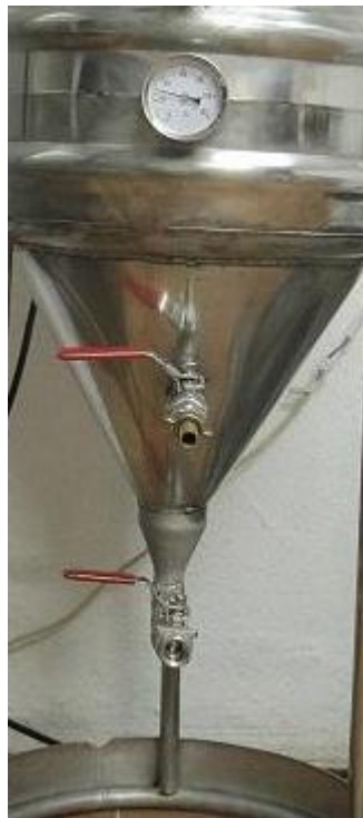
Fig 48: Termòmetre bimetàl·lic al cos del tanc i les dues vàlvules al con. Imatge pròpia
