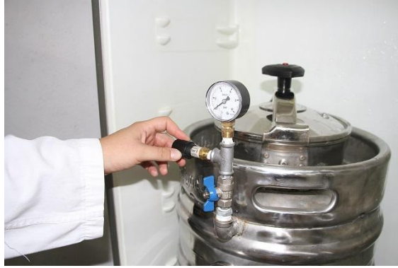
Fig 67: Configuració de la vàlvula reguladora de pressió. Imatge pròpia
