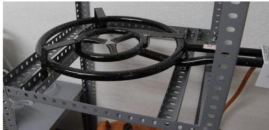
Fig 36: Sistema d'escalfament integrat en l'estructura. Imatge pròpia
