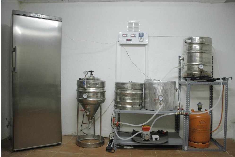
Fig 58: Dalt: quadre de control de temperatures. D'esquerra a dreta: cambra de fermentació, fermentador cilíndric, tanc de refredament, tanc de maceració i tanc de cocció/escalfament. A sota: bomba amb variador de freqüència i sistema d'escalfament
