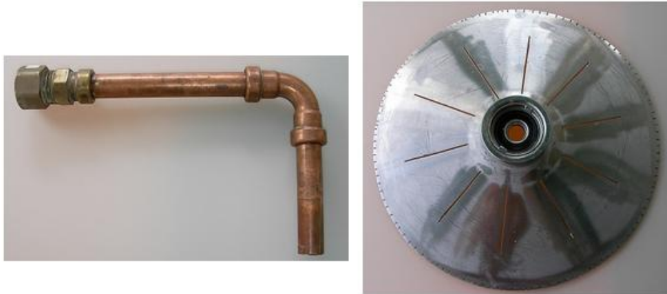
Fig 30: Tub de coure en forma d'ela (esquerra) i filtre (dreta). Imatge pròpia
