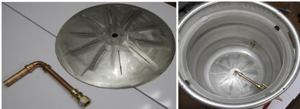
Fig 40: Filtre i tub en forma d'ela (esquerra) instal·lats al tanc de cocció/escalfament (dreta). Imatge pròpia
