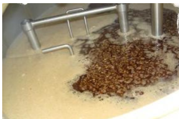
Fig 13: Pala mecànica mescla el gra i l'aigua per al procés de maceració en la cerveseria artesana Sagra
