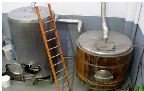
Fig 16: Tanc de cocció (a l'esquerra) de la Companyia Cervesera del Montseny
