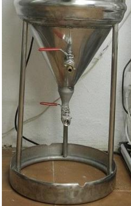
Fig 47: Tanc de fermentació amb l'estructura de suport. Imatge pròpia
