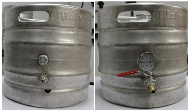
Fig 29: Perforacions de les entrades amb el mascle soldat i termòmetre bimetàl·lic i vàlvula instal·lats. Imatge pròpia
