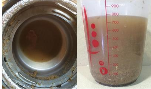
Fig 60: Líquid acumulat al fons del tanc de maceració (esquerra) i mesurat en un recipient volumètric (dreta). Imatge pròpia
