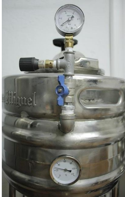
Fig 51: Sistema de regulador de pressió instal·lat al tanc de fermentació. Imatge pròpia
