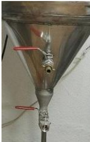
Fig 46: Con invertit amb les dues vàlvules instal·lades. Imatge pròpia
