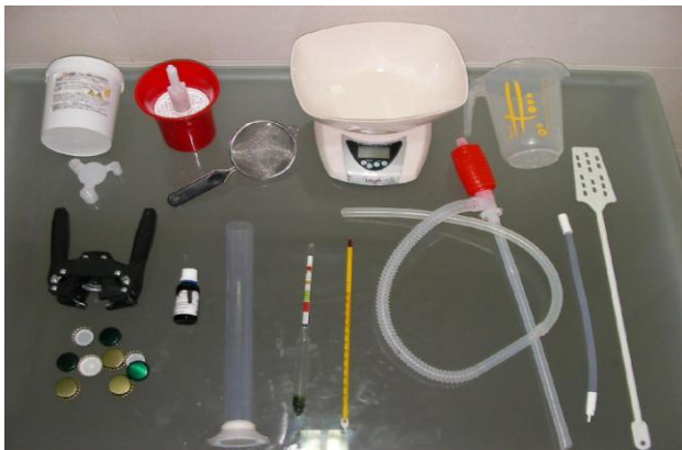
Fig 25: Eines i utensilis emprats junt amb el kit homebrewer
