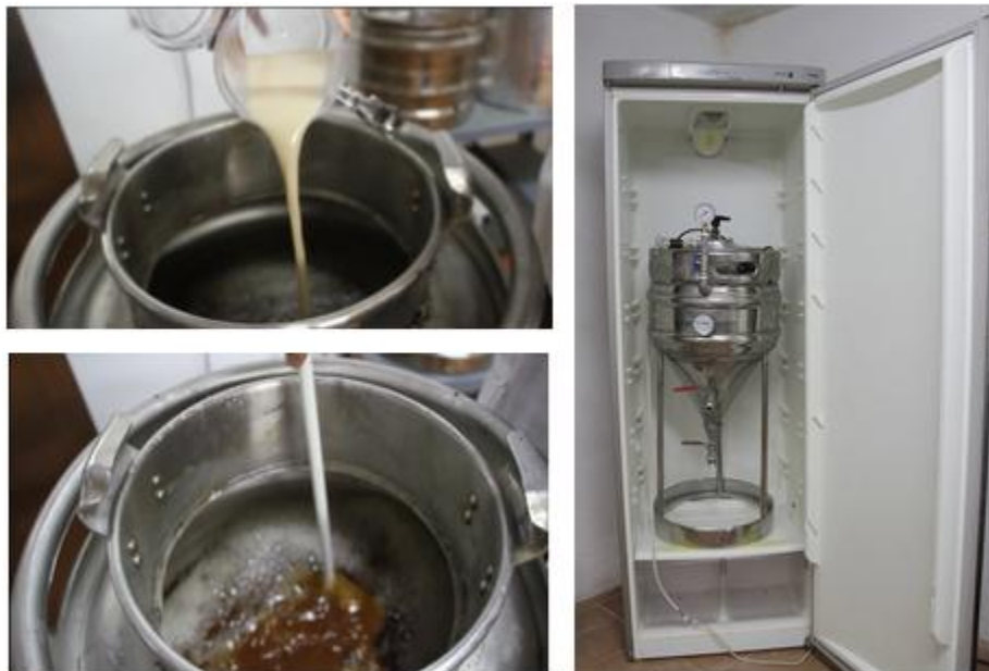
Fig 66: Inoculació del llevat (dalt), aireig del most (a sota) i fermentador cilíndric en la cambra de fermentació (dreta). Imatge pròpia
