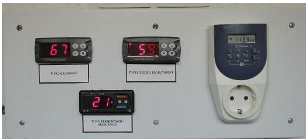
Fig 57: Quadre de control de l'equip. D'esquerra a dreta i de dalt a baix: T a maceració, T a coccio/escalfament, interruptor amb temporitzador i T a fermentació/maduració. Imatge pròpia
