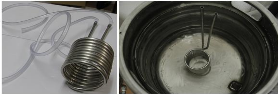
Fig 42: Serpenti d'acer inoxidable connectat als tubs de silicona (esquerra) i tanc de refredament (dreta). Imatge pròpia
