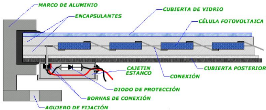
Figura 1.1.16.1. Estructura de módulo fotovoltaico tipo.
