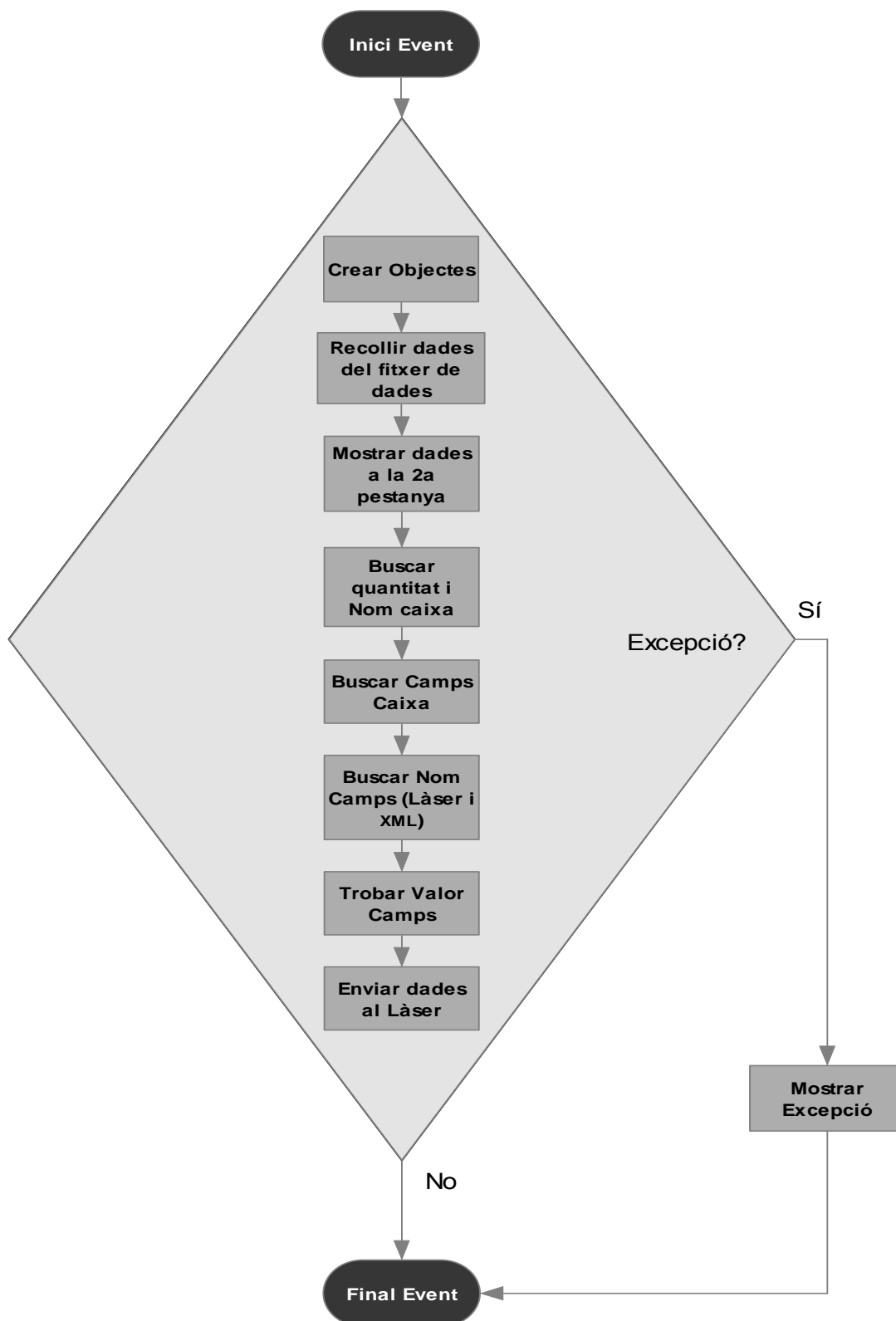
Diagrama 3.5.3 - Diagrama de funcionament de buttncarregaDades_Click.
