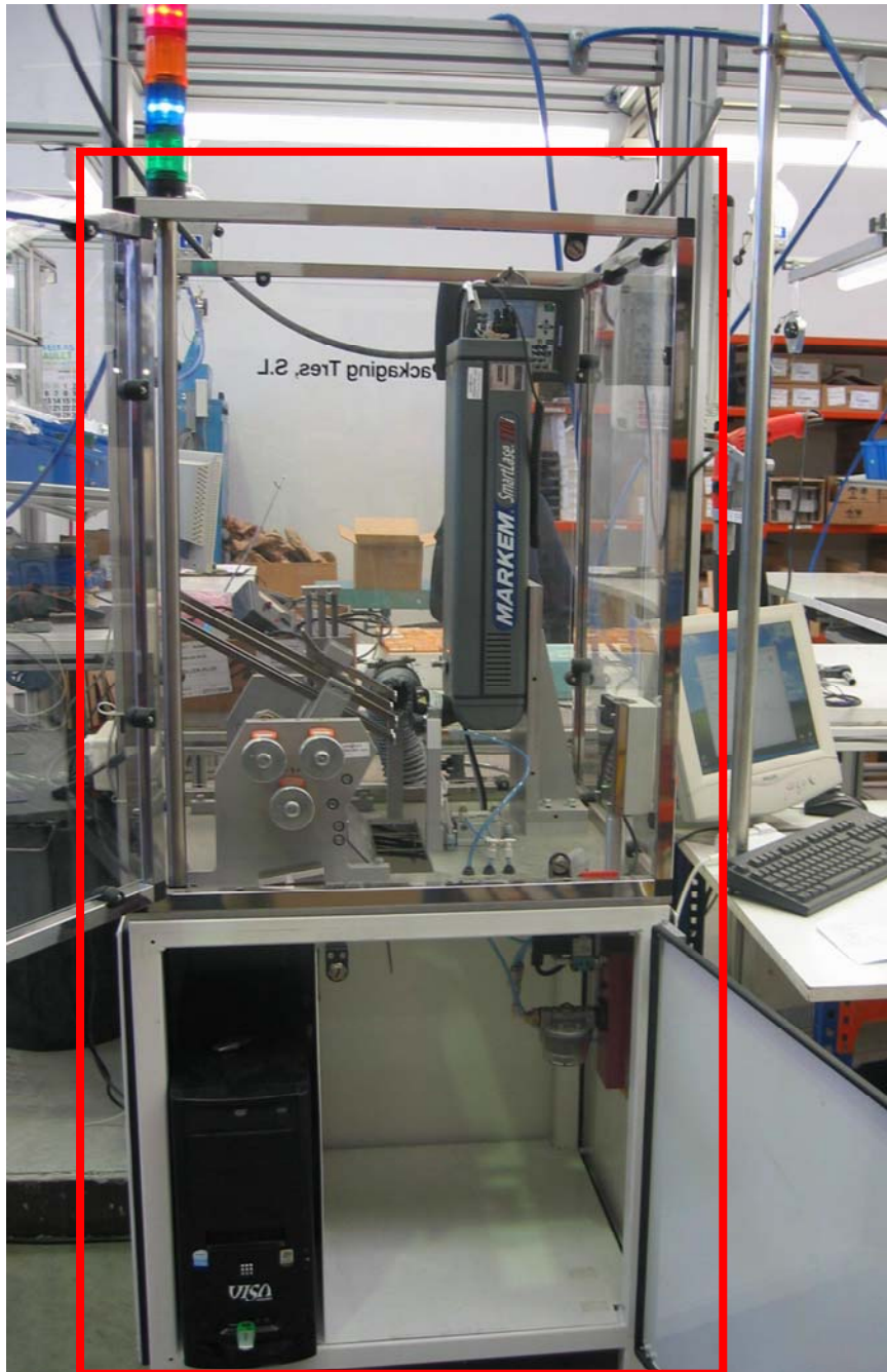
Figura 4.1.1 - Màquina manipuladora de caixes.
