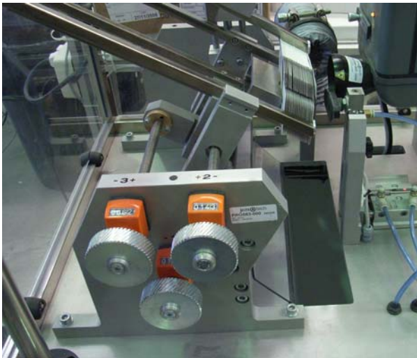
Figura 4.1.3 - Mecanisme de col·locació de caixes davant del làser.
