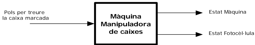
Diagrama 4.1.1 - Diagrama de les senyals I/O de la màquina.
