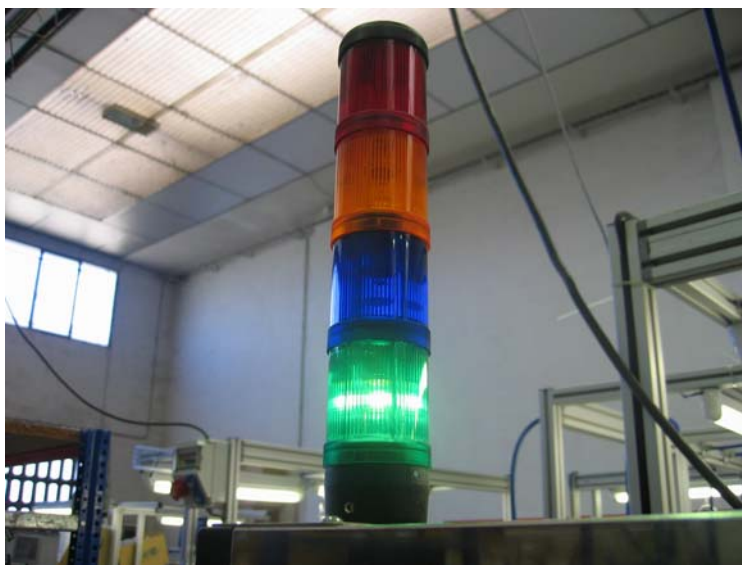
Figura 4.1.2 - Semàfor de la màquina manipuladora de caixes.
