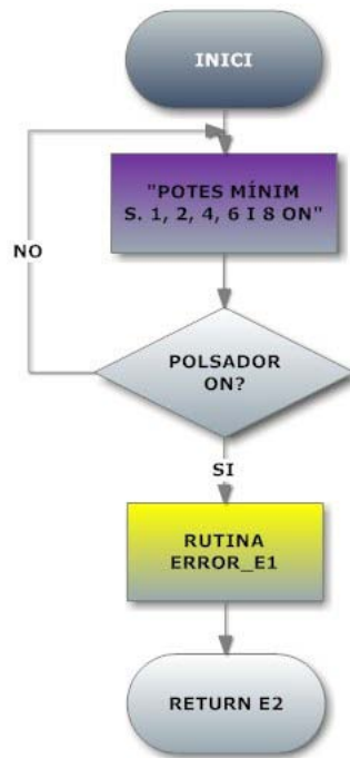
Figura 6.4.5 – Diagrama de flux de l'estat E1
