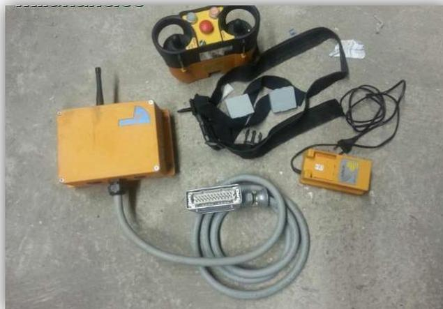
Fig. 8. Equipo completo de control de una torre grúa
