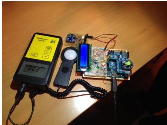
Figura 4-1. Calibratge fotoresistència LDR amb luxímetre
