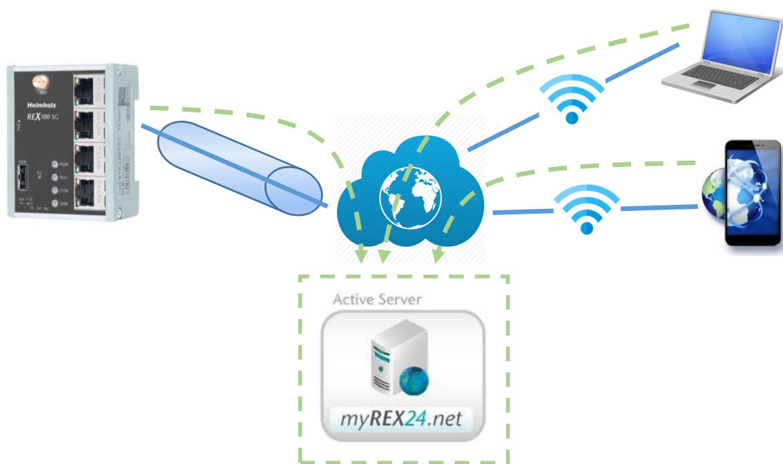
Figura 5.19 - Esquema general de comunicació amb el servidor
