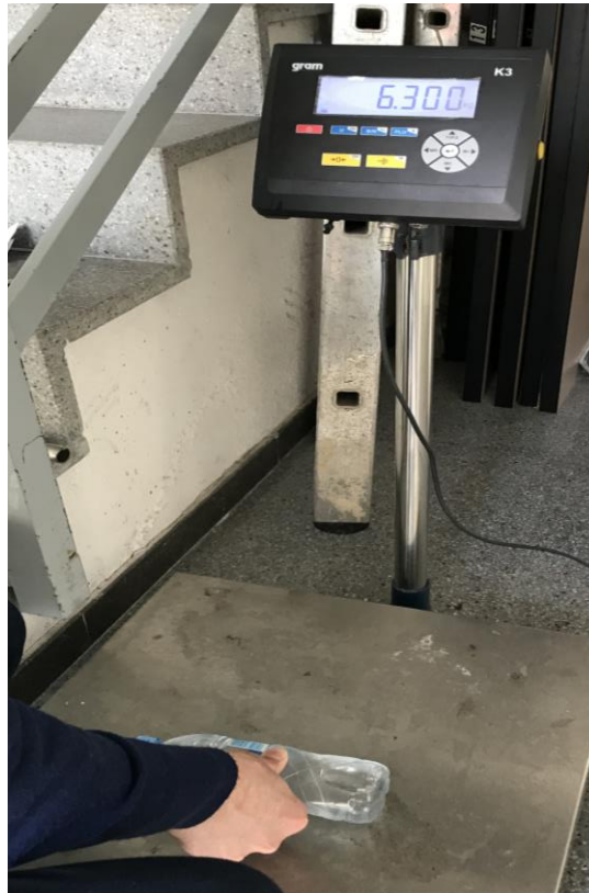
imatge 73: demostració d'obtenció de la força de deformació.
