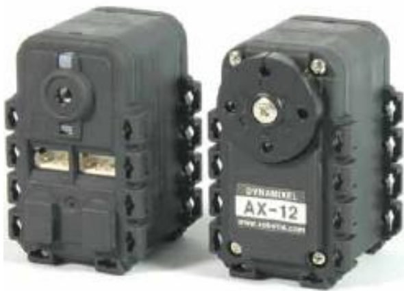
imatge 43: geometria motor Dynamixel ax-12.
