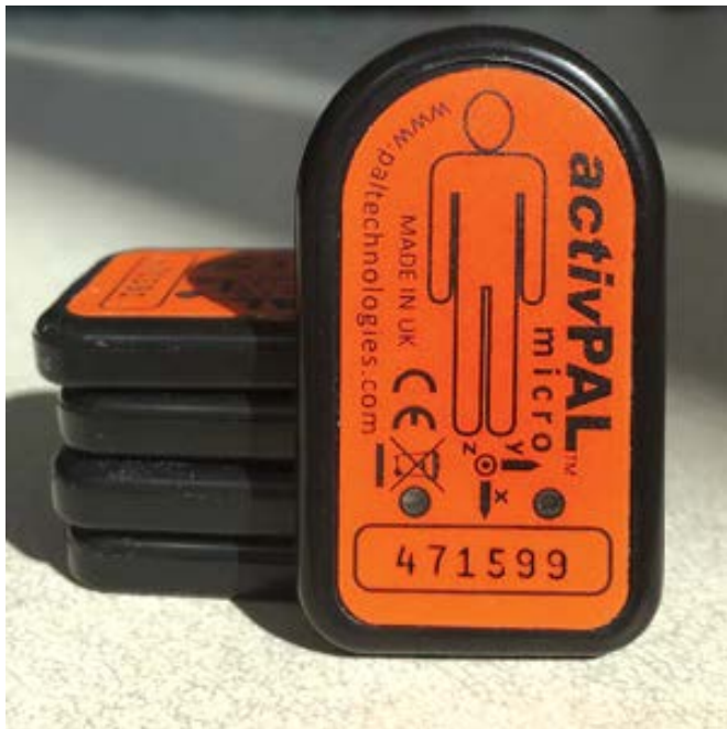
Figura 3: Exemple de sensor de moviment ActivPAL3™ fabricat per PAL Technologies Ltd, Glasgow, Regne Unit, ( http://www.paltechnologies.com )
