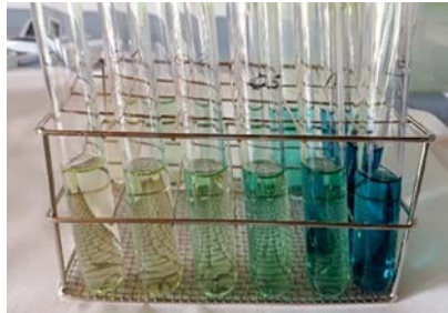
Figura 8. Patrons per a la determinació de la concentració d'amoni.
