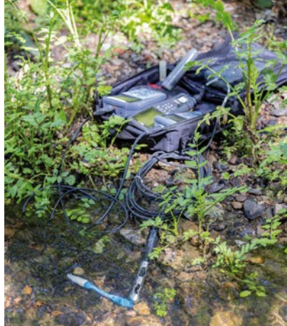
Figura 7. Sondes de conductivitat elèctrica, pH i oxigen.
