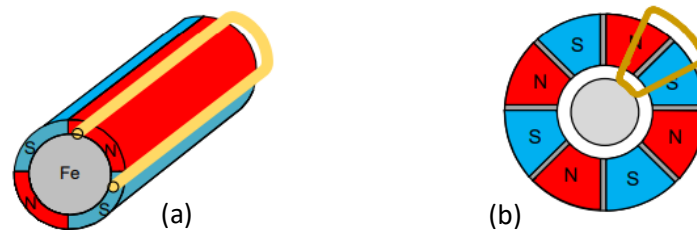
Figura 15: Distribución del flujo magnético de un motor radial y axial [13]
