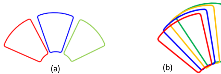
Figura 26: Representación de los dos bobinados con las distintas fases [13]
