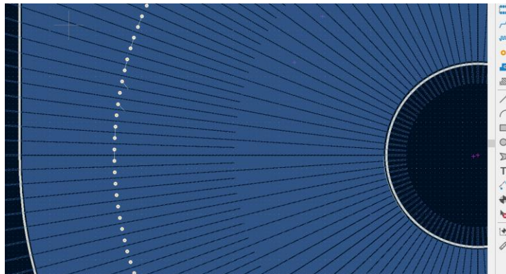
Figura 32: Sistema de disipación de calor y disminución de corrientes de Foucault parte inferior
