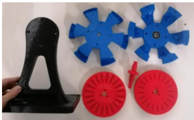
Figura 40: Conjunto total de piezas del motor impresas en 3D
