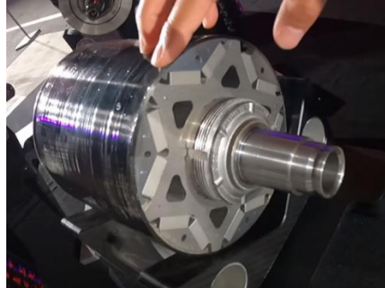
Figura 22: Rotor de imanes permanentes (Tesla model 3)
