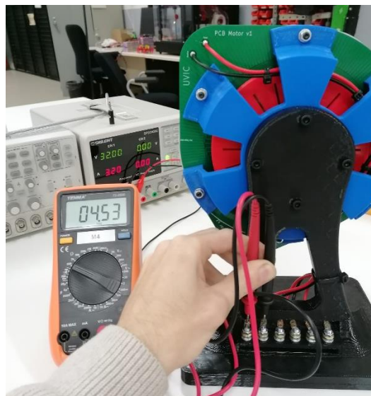
Figura anexo 32: Medición óhmica del bobinado con doble PCB soldada
