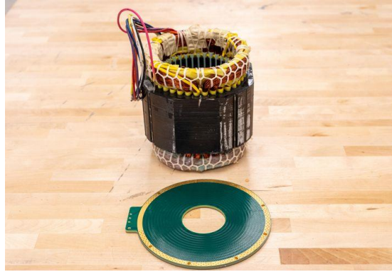
Figura 23: Estátor de un motor radial comprado con un estátor en PCB (Infinitum PCB Motor)
