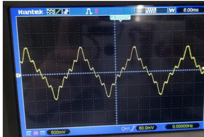
Figura 47: Onda de una fase del motor vista en el osciloscopio (doble rotor)
