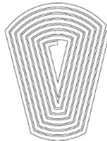
Figura 24: Tipo de bobinado concéntrico [4]
