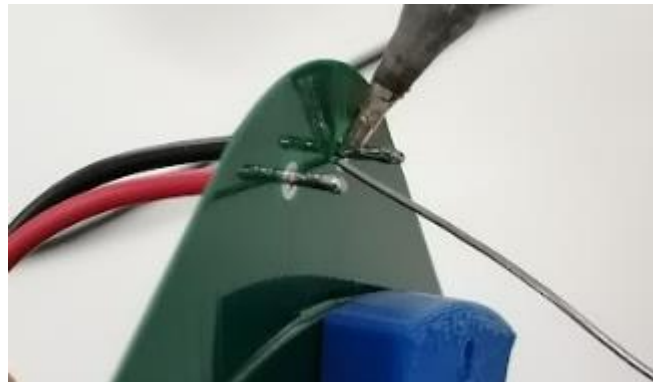
Figura anexo 27: Soldadura cableado fase/neutro con PCB
